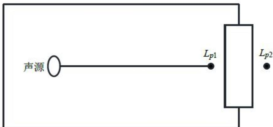
图 4-5 室内声源等效为室外声源图例
