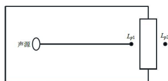
图 4-2 室内声源等效为室外声源图例
