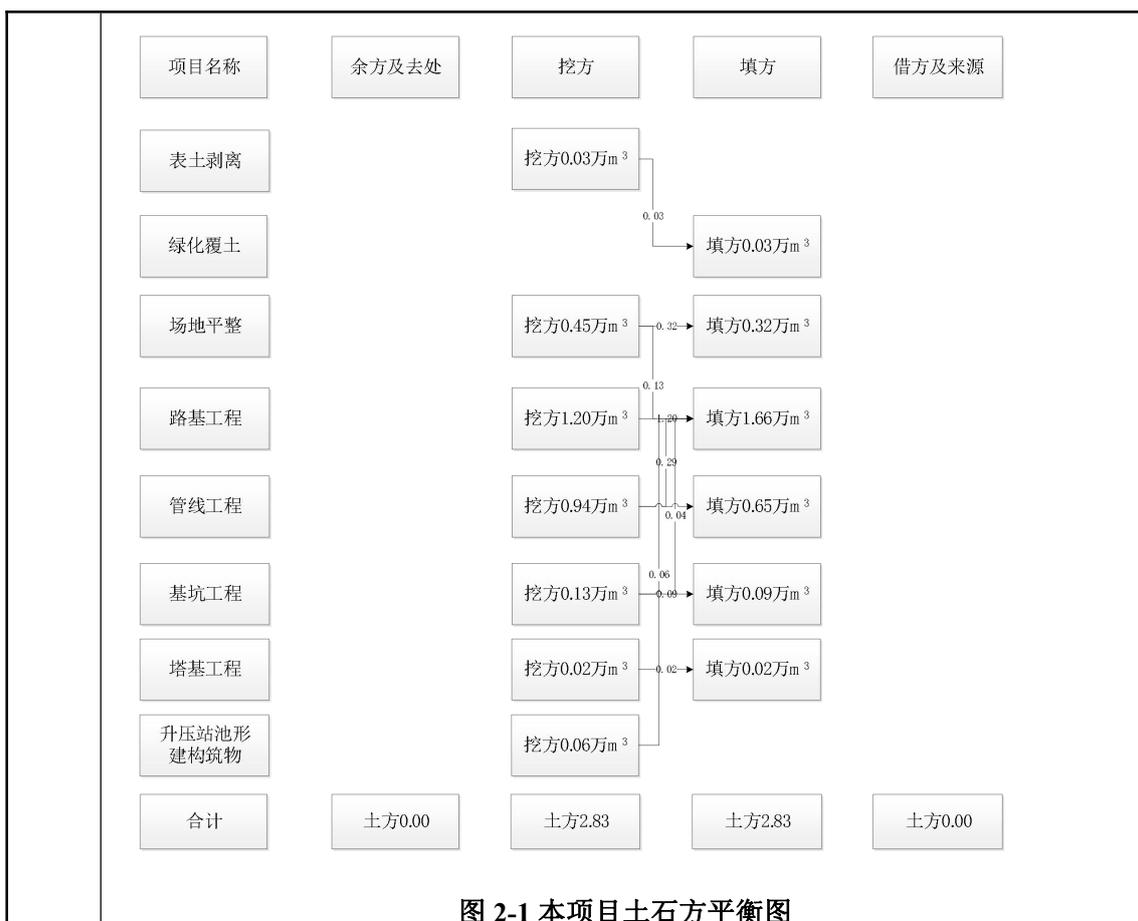
图 2-1 本项目土石方平衡图
