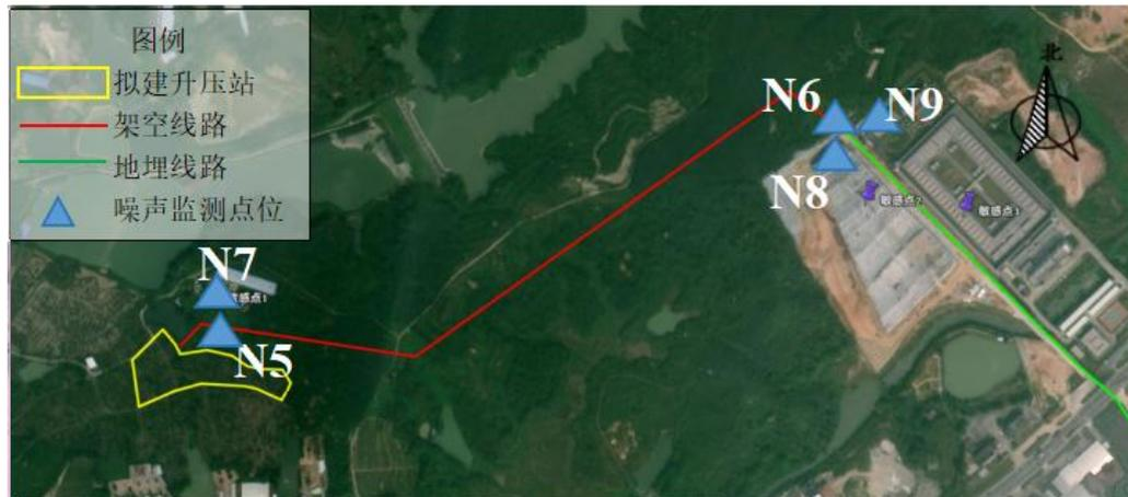
图 3-5 送出线路及敏感点声监测布点图
