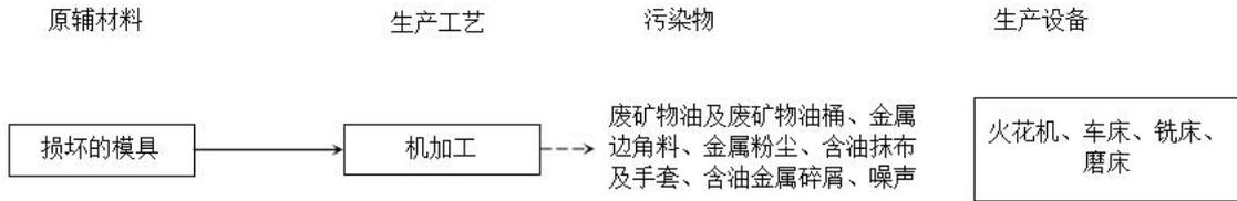
图 2-3 模具维修工艺流程图
