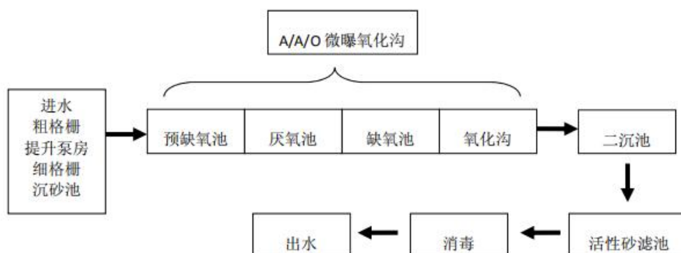
图 4-1 新美污水处理厂水处理工艺流程图
