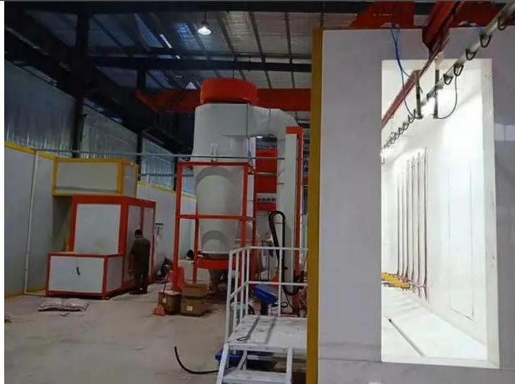
图 4-1 自动喷粉线收集系统示意图
