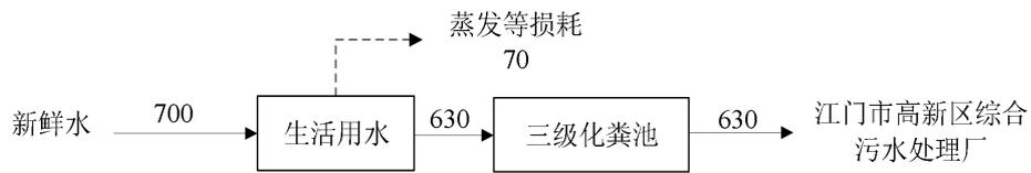
图 2-1 项目水平衡图 单位: t/a
