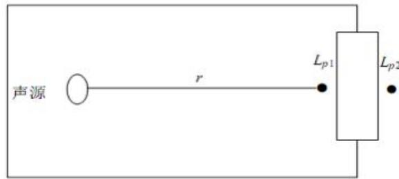
图42 室内声源等效为室外声源图例
