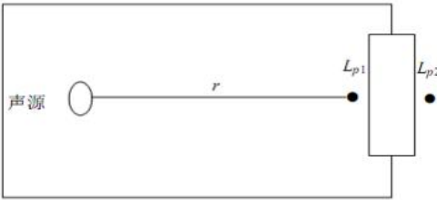
图4-2 室内声源等效为室外声源图例
