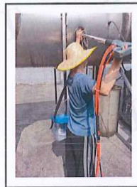
2#厂房投料、密炼、开炼废气 2#DA003 处理前
