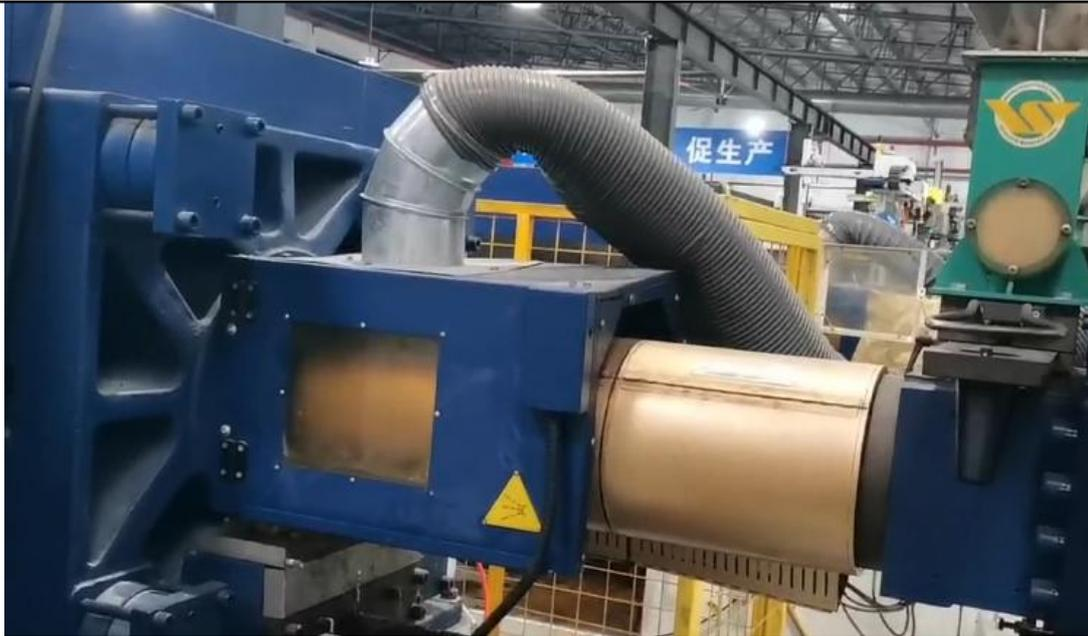
图 4-1 注塑机、拉管机收集示意图
