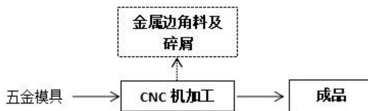
图 2-2 五金模具加工工艺流程图
