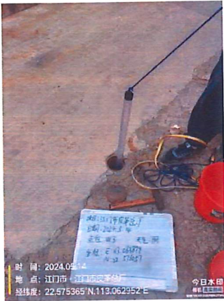
7: W3 地下水采样口
