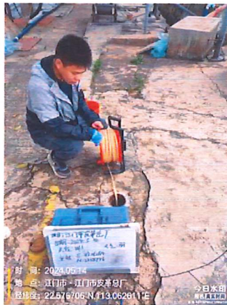
3: W1 地下水采样口
