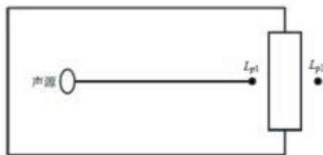
图 4.2 室内声源等效为室外声源图例
