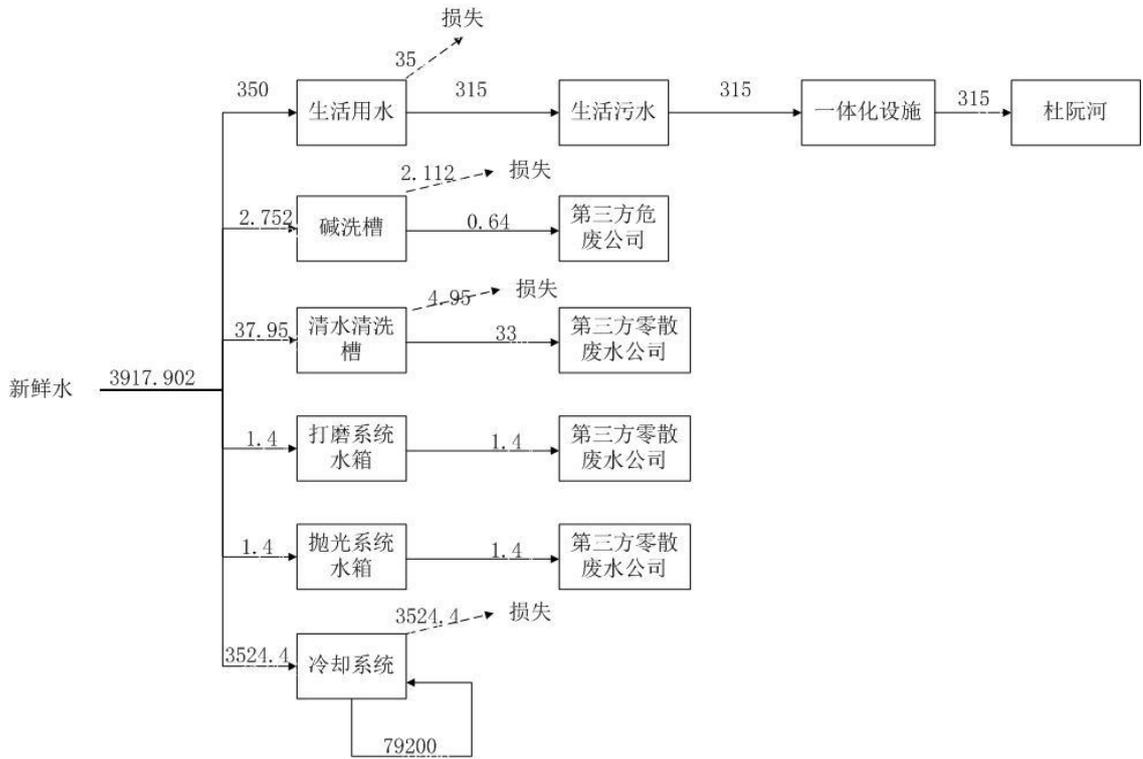
图 2-1 近期水平衡图 (单位:  $\text{m}^3/\text{a}$ )
