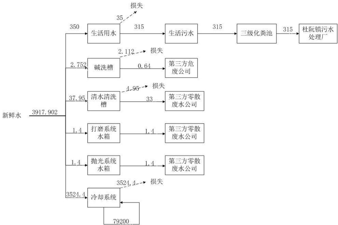
图 2-2 远期水平衡图 (单位:  $\text{m}^3/\text{a}$ )
