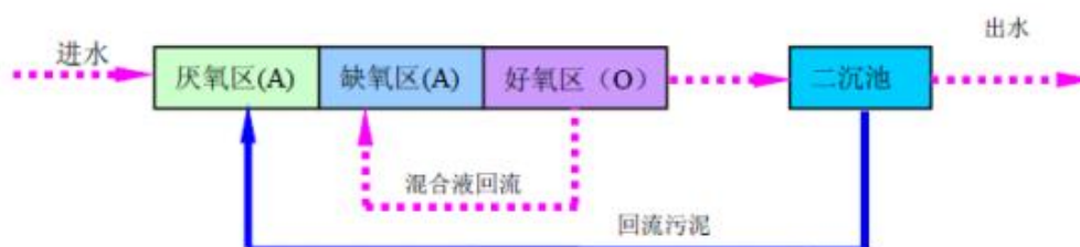
图 4-2 改良 A 2 /O 法一体化设备工艺流程图
