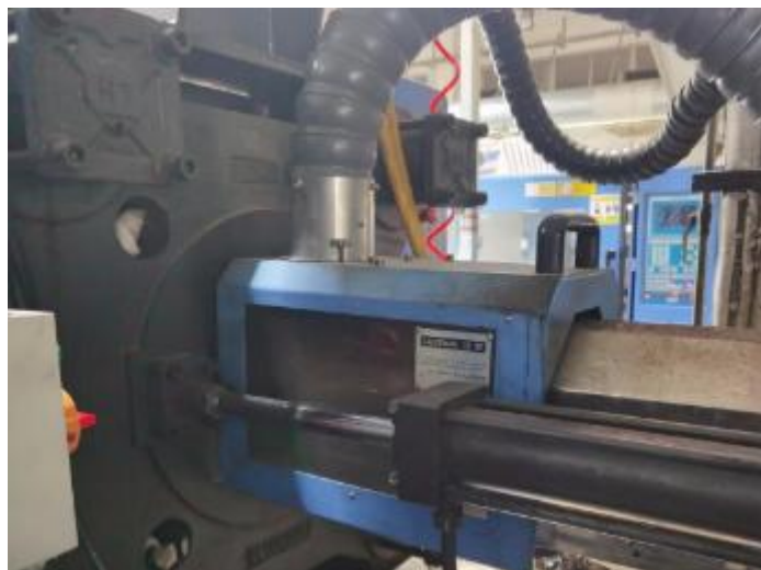
图 4-1 注塑废气收集
