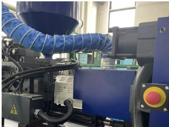
**图 4-1 集气罩收集方式**
