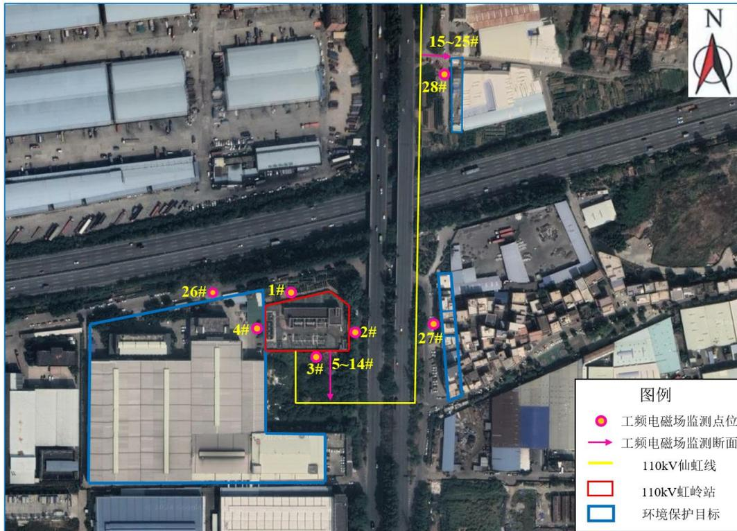
图 14 110kV 虹岭变电站电磁环境监测点位图
