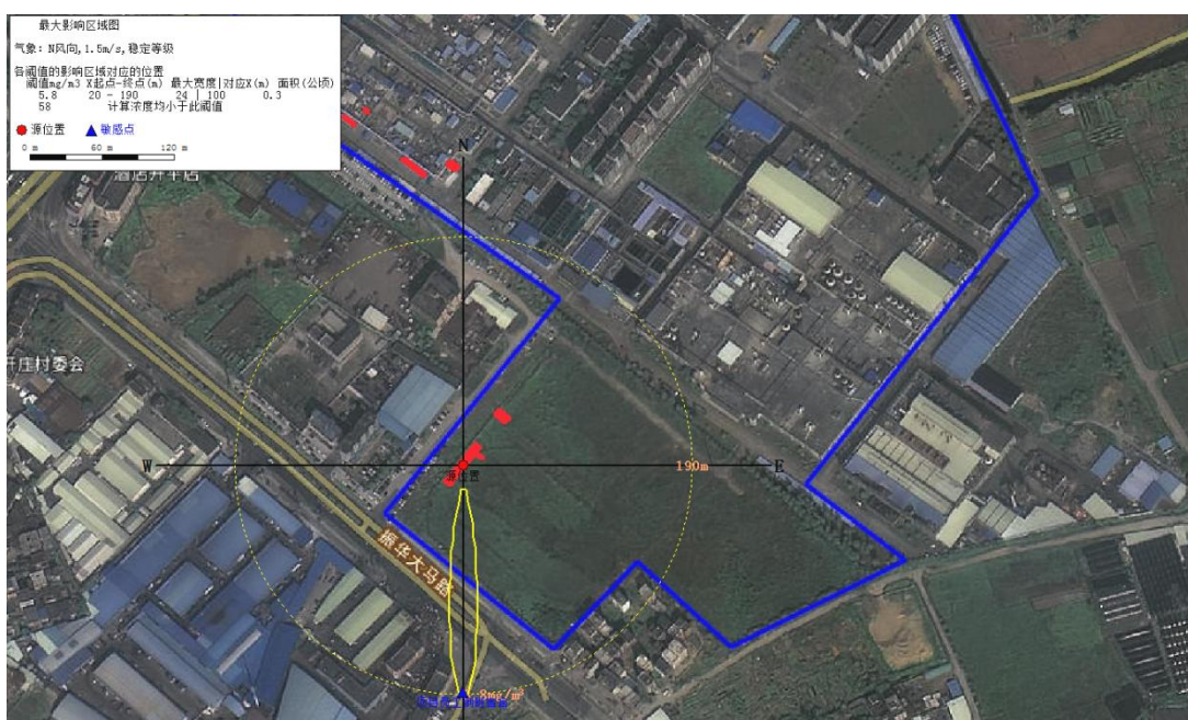
图 2.6.1-2 生产废气管道泄漏事故排放在下风向最大影响区域图（最不利气象条件）
