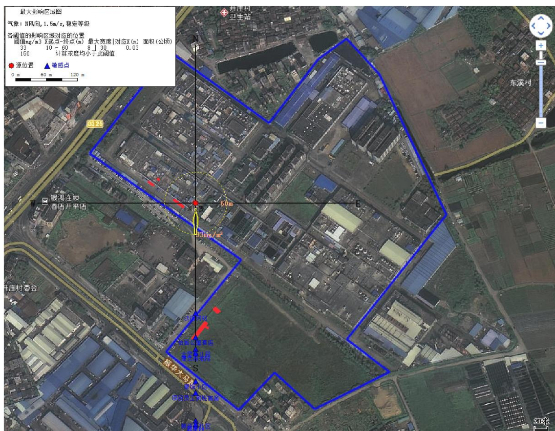
图 2.6.1-1 盐酸泄漏蒸发事故排放在下风向最大影响区域图（最不利气象条件）
