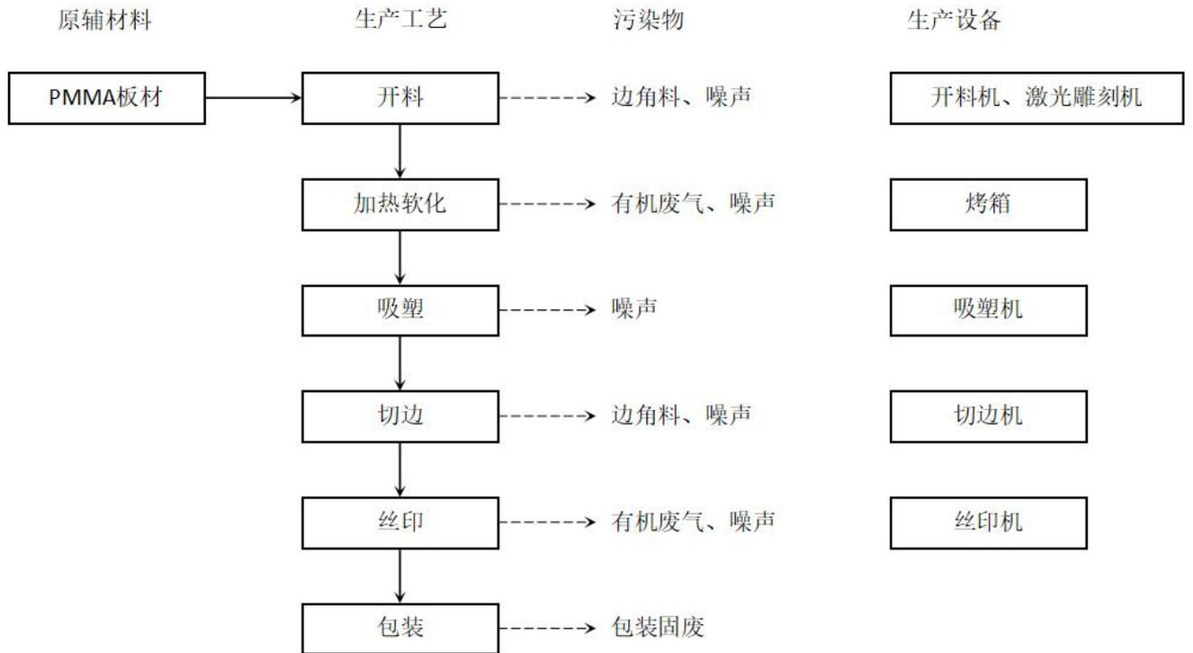
**图2-2 塑料制品生产工艺流程图**
