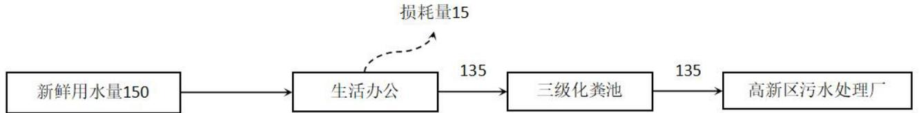
**图 2-1 项目水平衡图 (t/a)**
