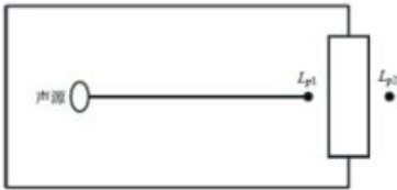
图 4-2 室内声源等效为室外声源图例
