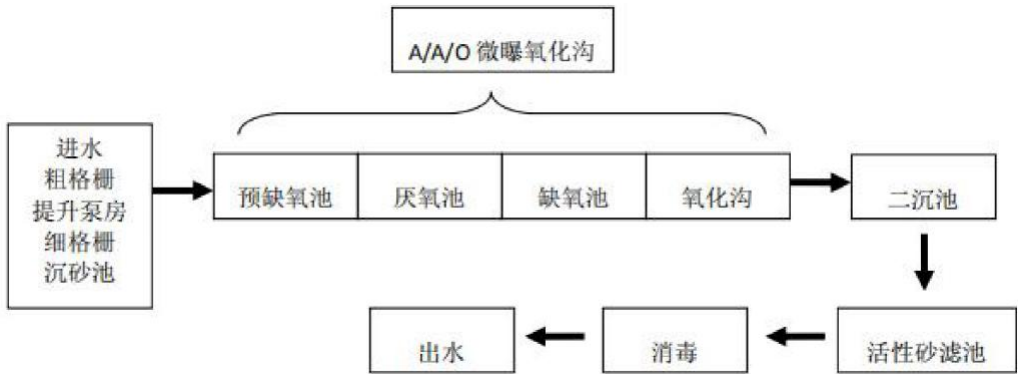
图 2. 开平市新美污水处理厂处理工艺流程图
