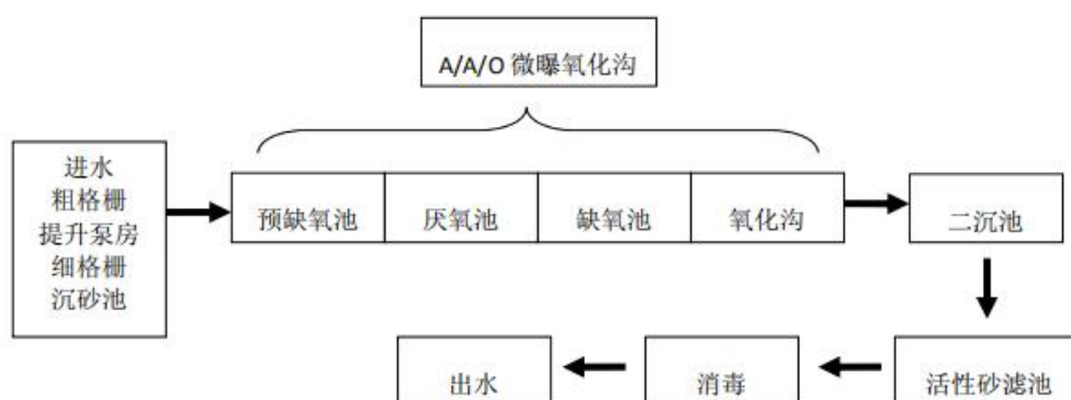
图 4-1 新美污水处理厂水处理工艺流程图
