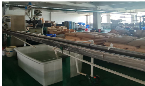
图 4-2 PVC 灯带直接冷却水装置示意图
