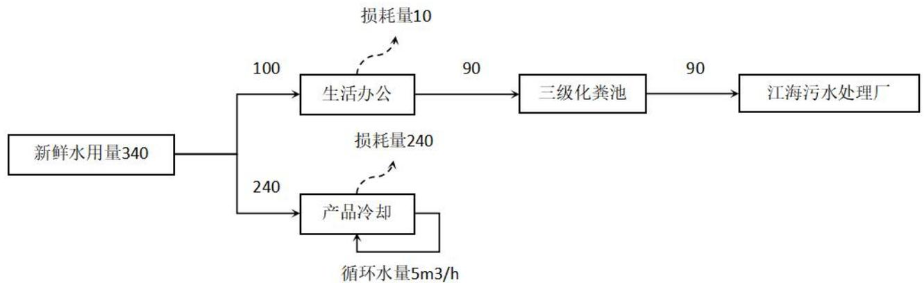
图 2-1 项目水平衡图 (t/a)
