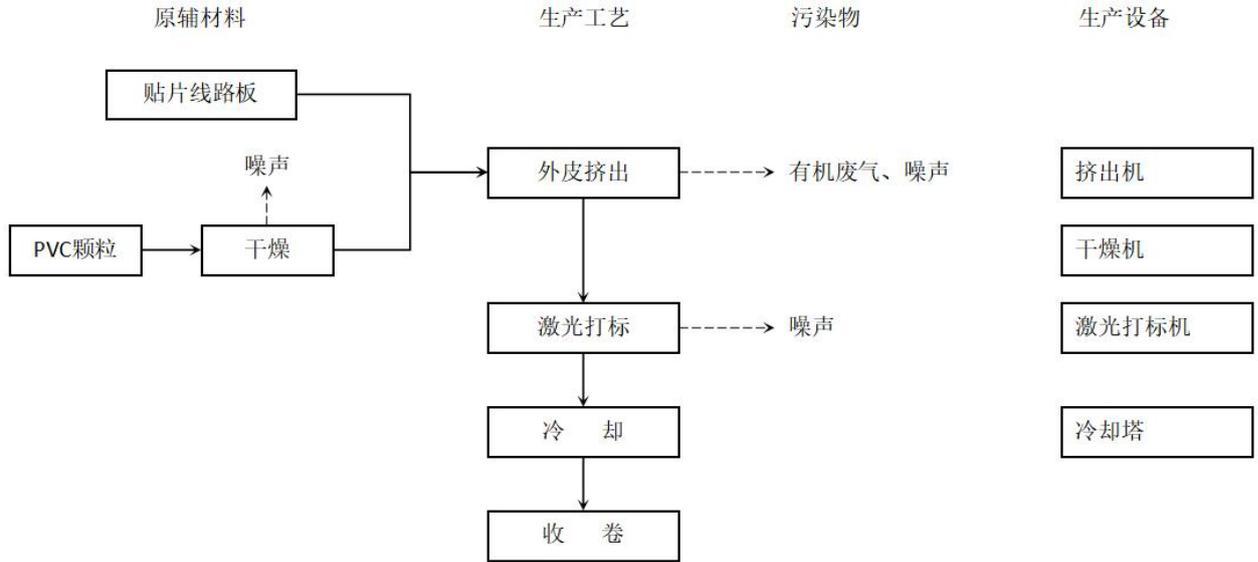
图2-2 LED灯带生产工艺流程图
