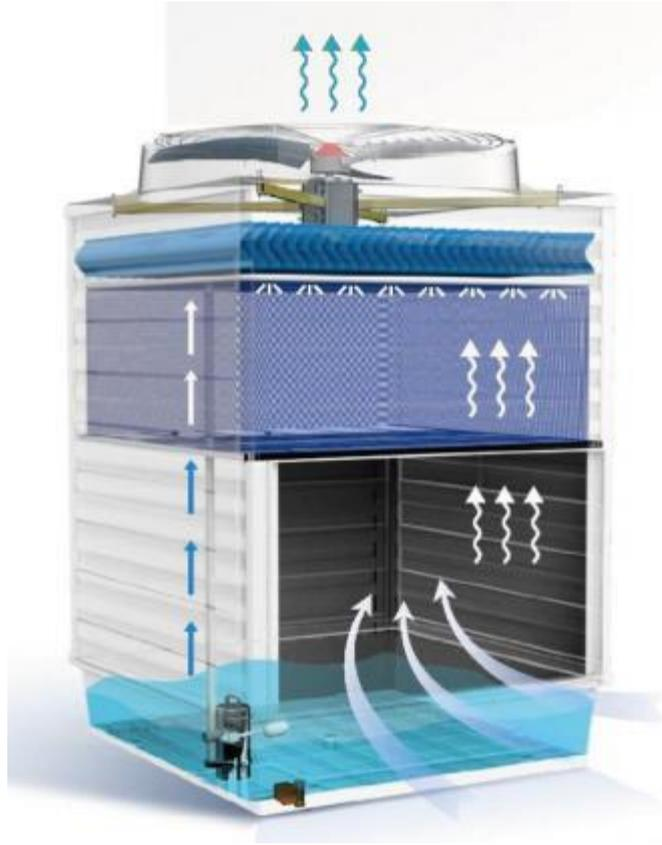
图 7.1-1 生物喷淋除臭装置原理图
