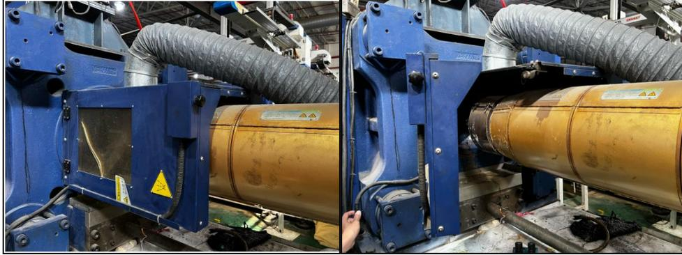
图4-1 注塑废气收集示例图
