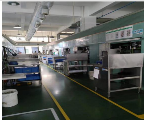
硫化作业区（无法密闭的操作口）
