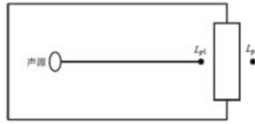
图 4-2 室内声源等效为室外声源图例
