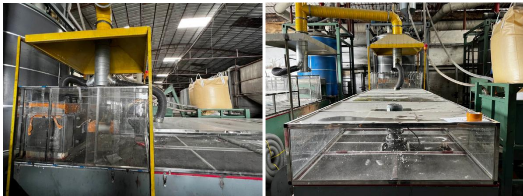
图 4-1 挤出废气收集系统示意图
