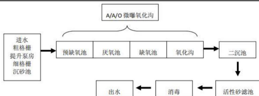
图 4-1 新美污水处理厂工艺流程图
