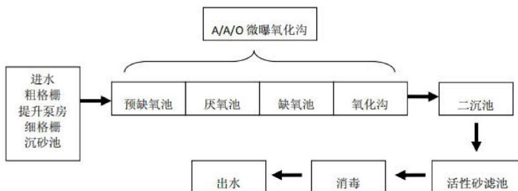
图6 开平市新美污水处理厂处理工艺流程图
