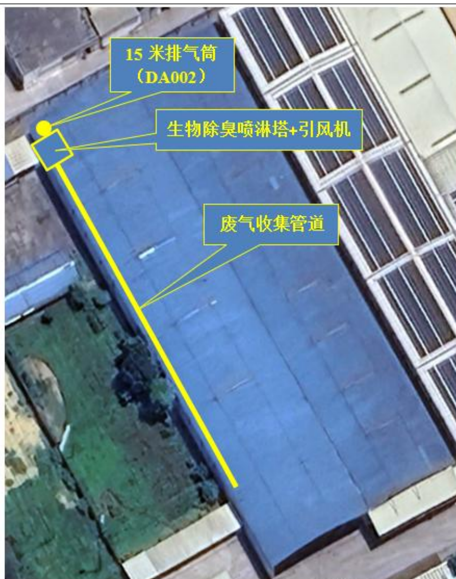
图 2-7 项目原料仓废气收集管道及末端治理措施布设示意图
