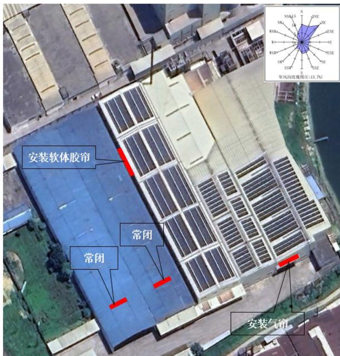
图 2-6 项目原料仓出入口整改示意图
