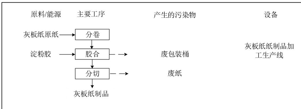
图 3.2-3 灰板纸纸制品工艺流程图
