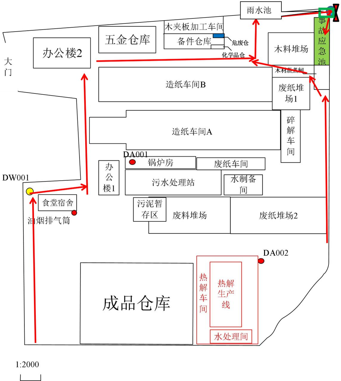
图 6.7-2 事故废水管网收集图
