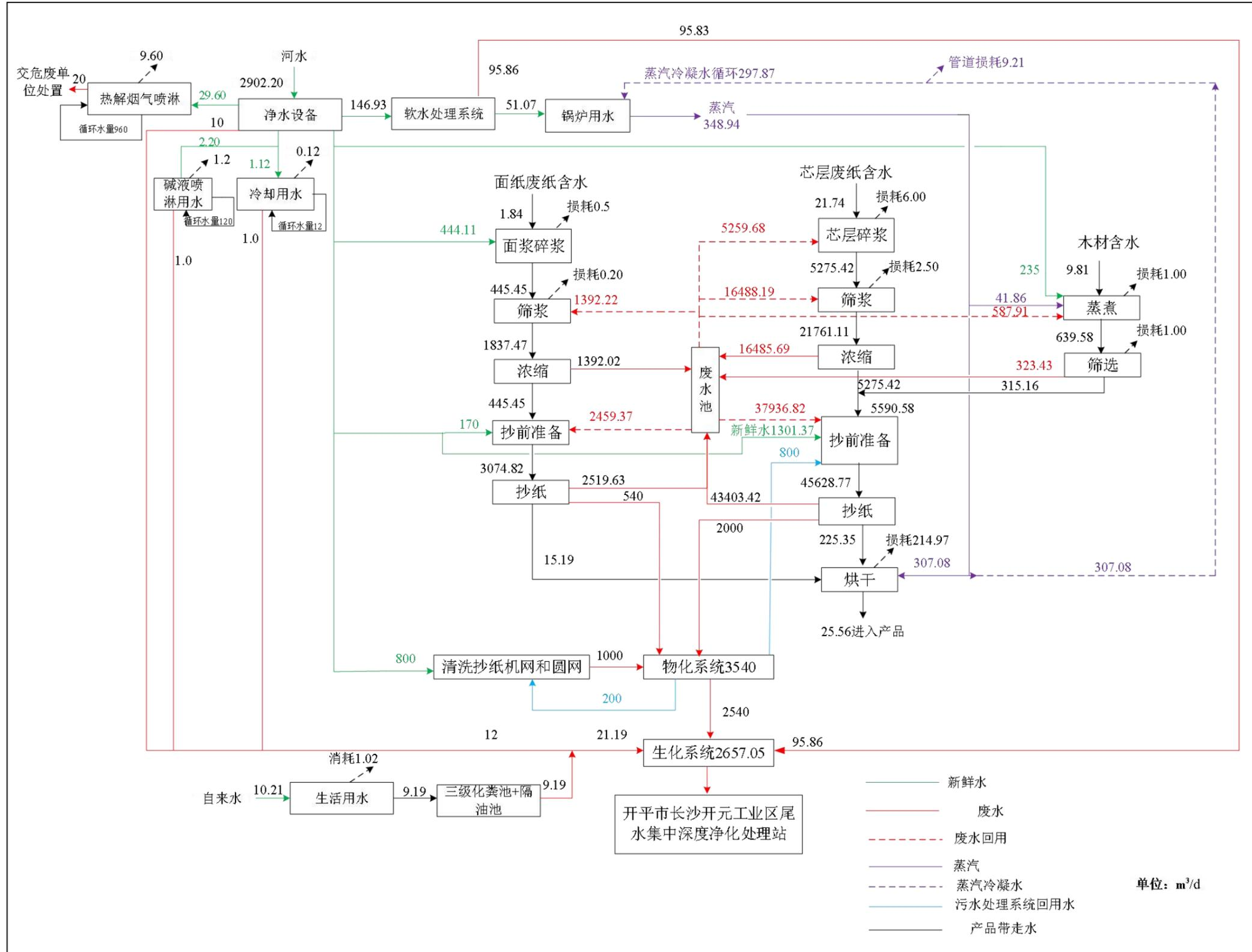
图 4.2-2 技改后全厂水平衡图
