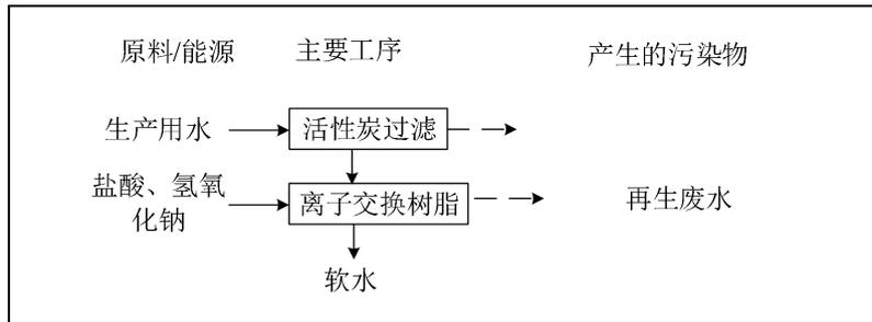
图 3.2-6 软水制备工艺流程图
