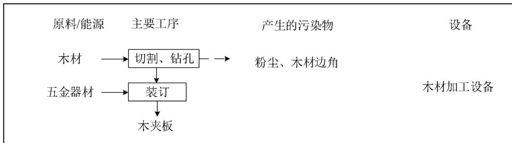
图 3.2-4 木夹板加工工艺流程图
