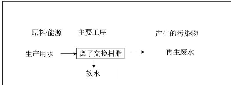
图 4.3-3 软水制备工艺流程图
