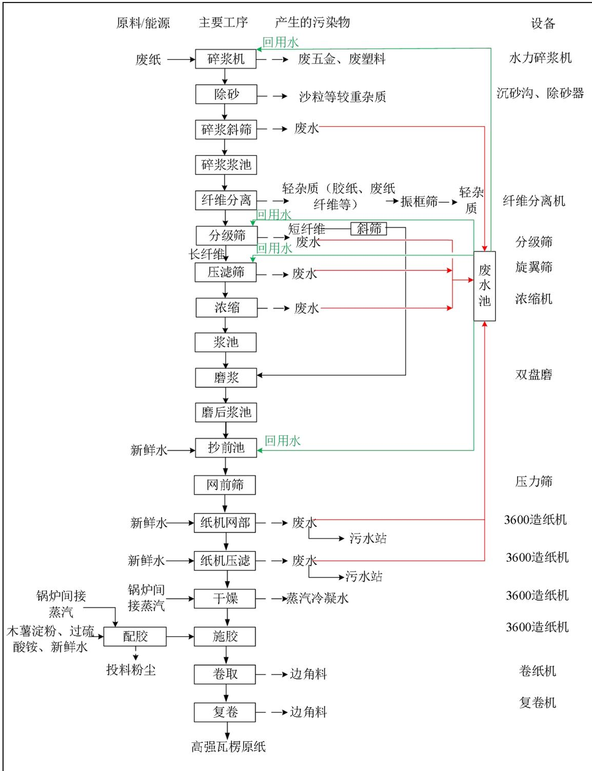
图 3.2-1 高强瓦楞原纸工艺流程图
