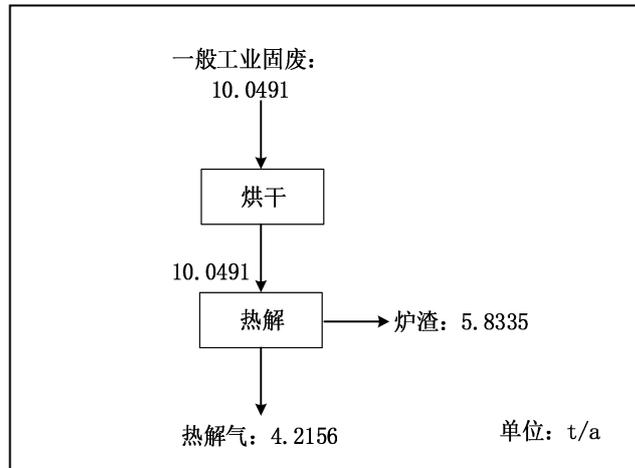
图 4.3-7 项目氯元素平衡图
