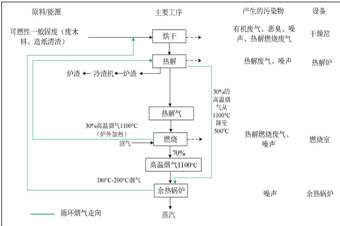
图 4.3-2 项目热解工艺流程图
