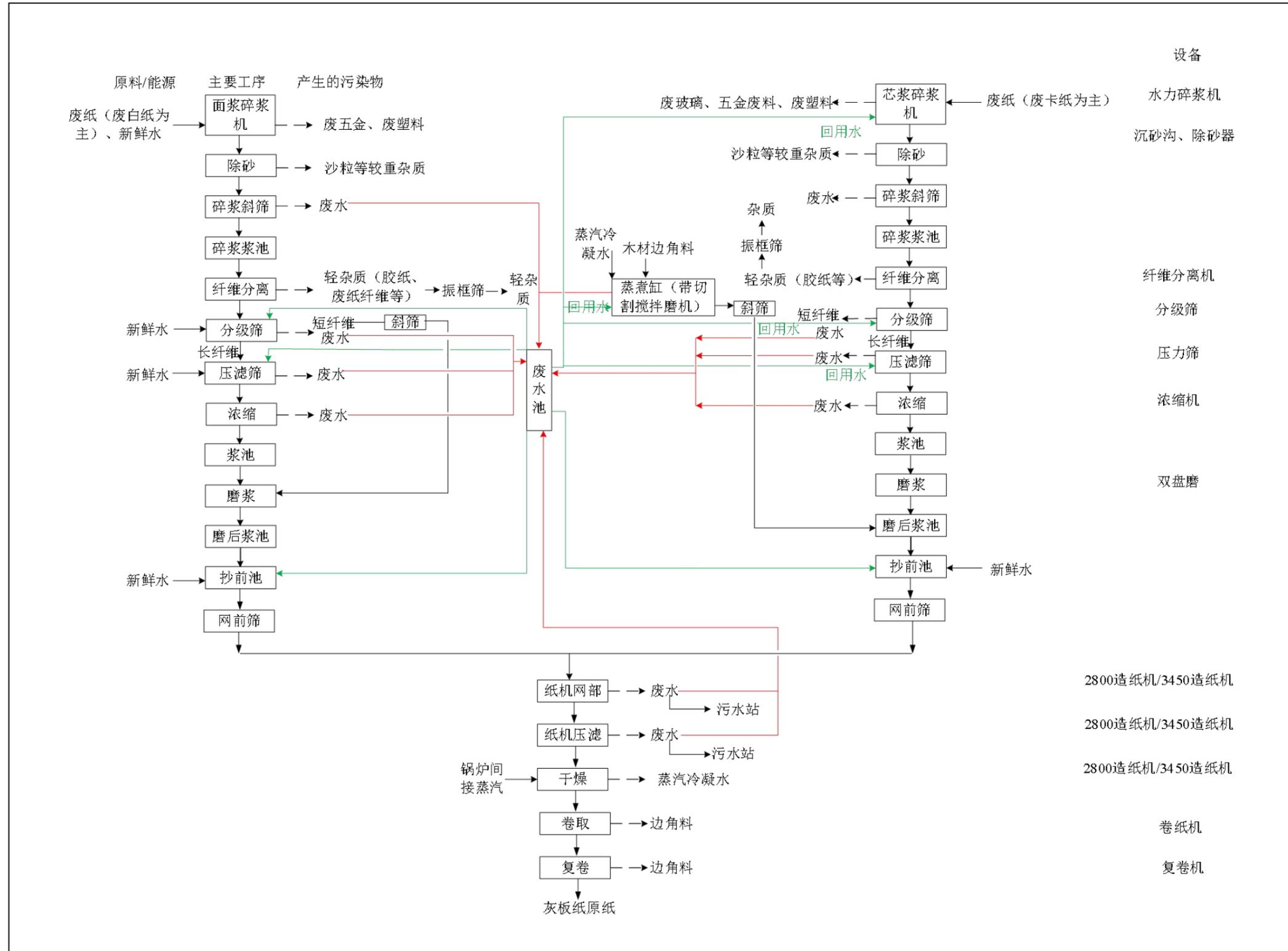
图 3.2-2 灰板原纸工艺流程图
