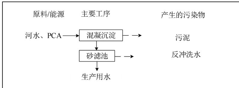
图 3.2-5 河水净化工艺流程图
