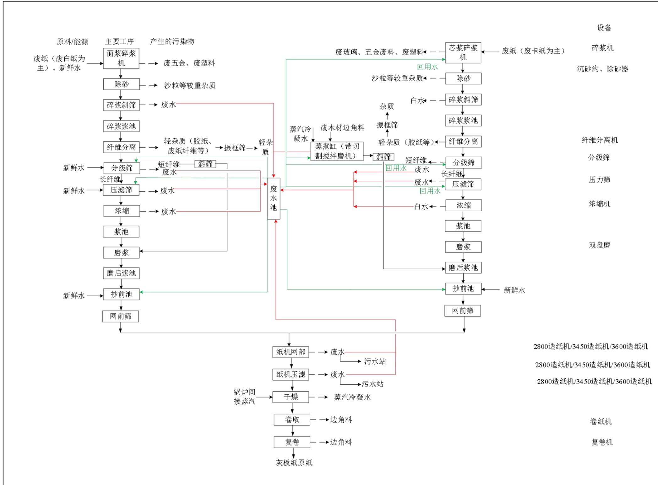
图 4.3-1 项目灰板原纸工艺流程图
