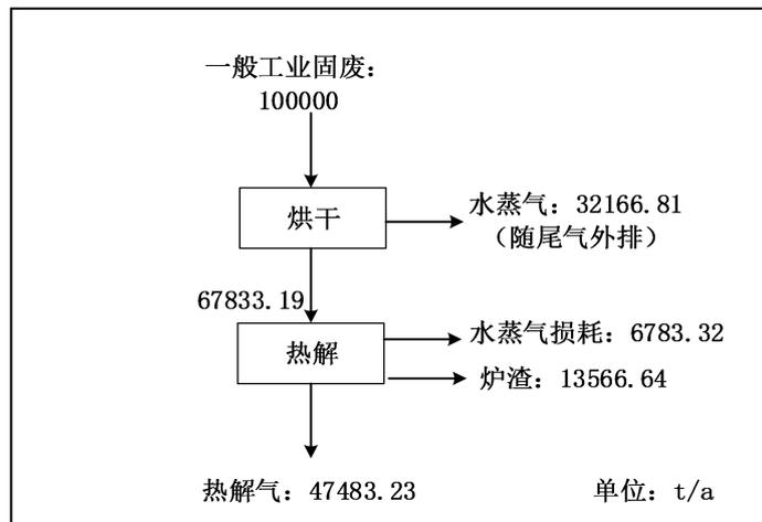
图 4.3-5 项目热解炉固废平衡图
