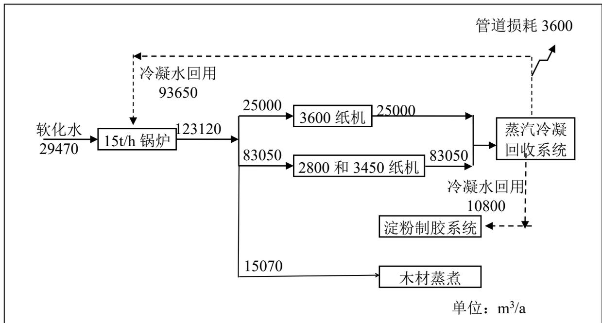
备注：淀粉制胶系统采用电能加热。
