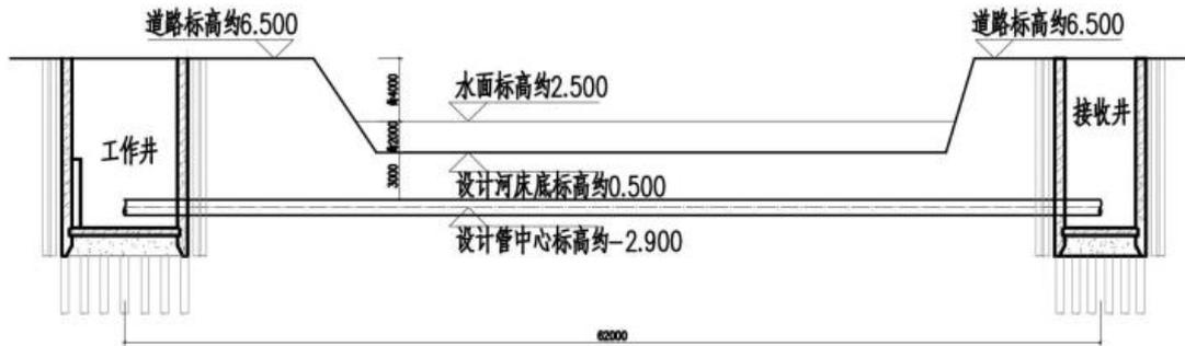
图 2-2 顶管下横穿杜阮河节点纵剖面图
