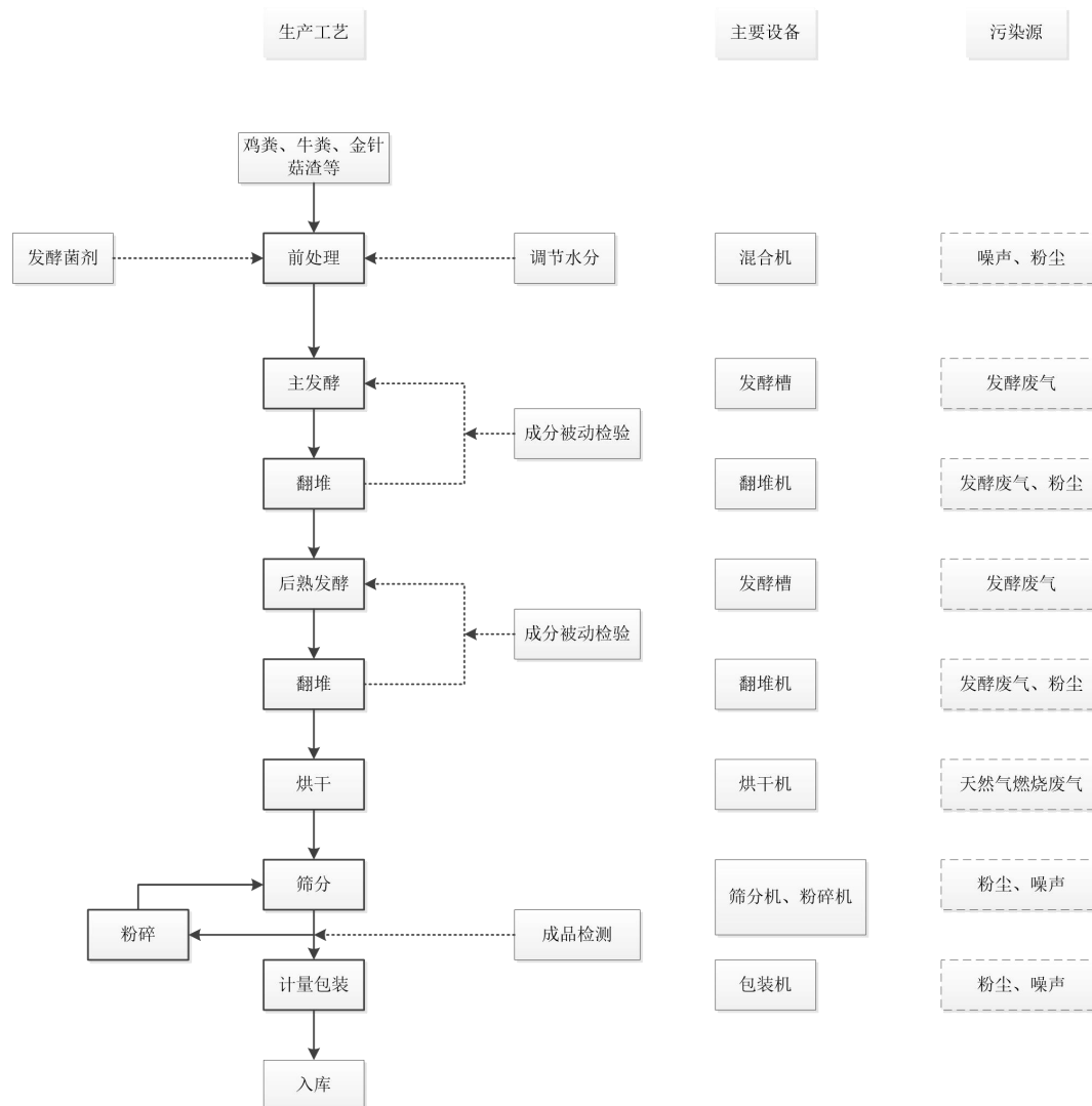
图 2-1 生物有机肥生产工艺流程及产污节点图
