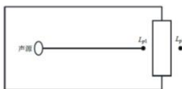
图4-2 室内声源等效为室外声源图例
