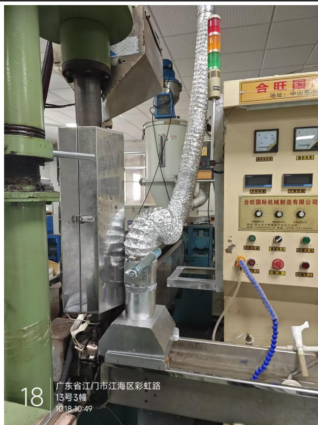
图 4-1 半密闭集气罩示意图
