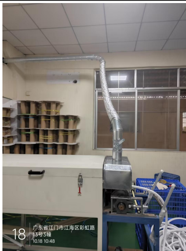
图 4-1 半密闭集气罩示意图
