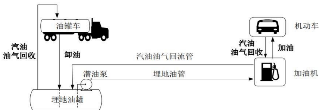
图 2-2 加油站设备衔接流程图
