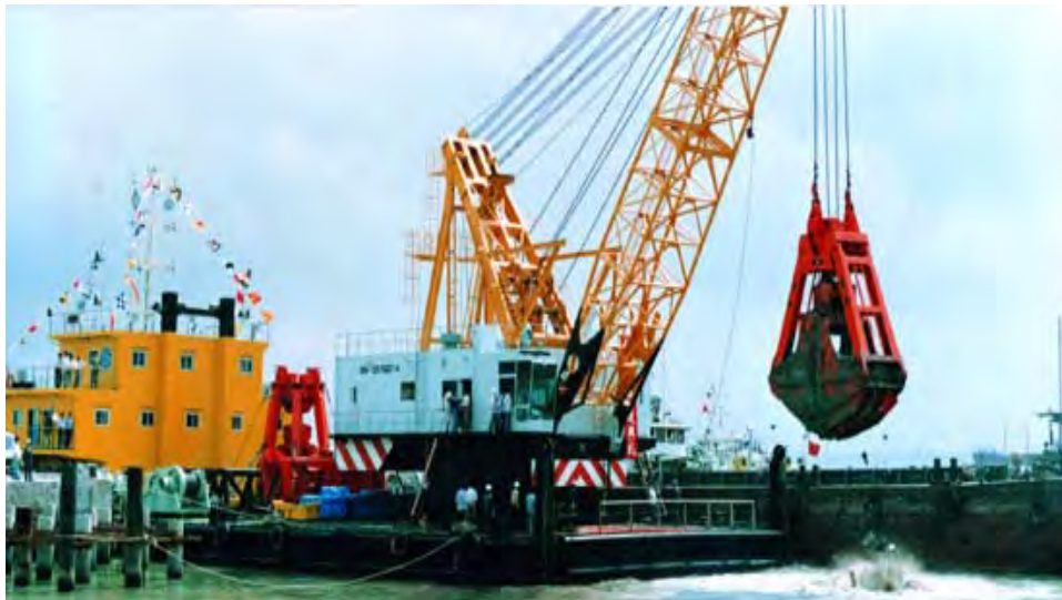
图 2.4.1-1 抓斗式挖泥船施工示意图
