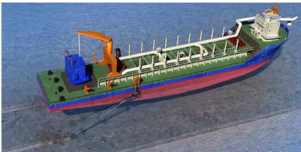
图 2.4.2-2 耙吸船施工三维示意图
