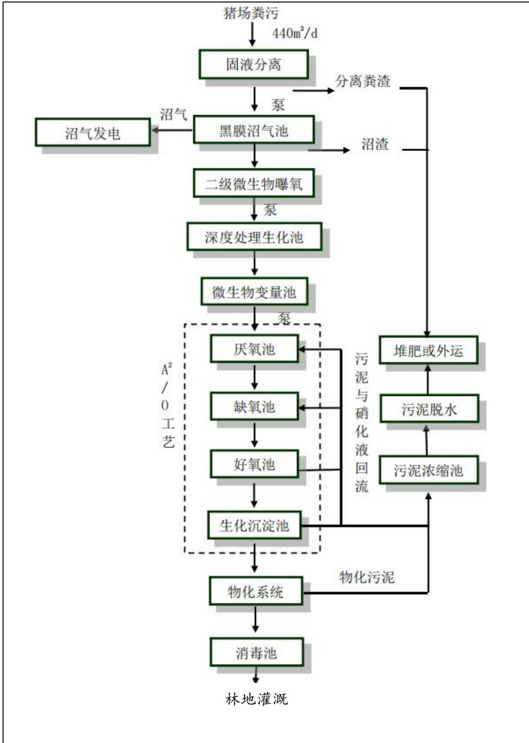
图 7.2-1 废水处理工艺流程图
