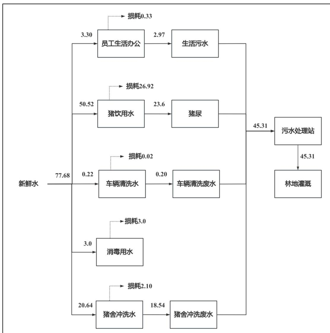
图 3.3-1 项目水平衡图
