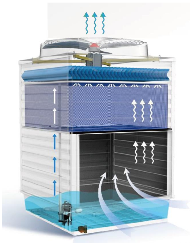
图 7.1-1 生物喷淋除臭装置原理图
