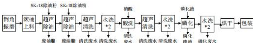
图 2-16 磷化工艺流程及产污环节图
