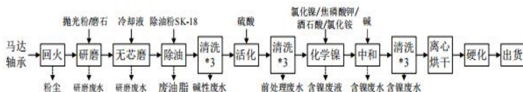
图 2-13 铁枝研磨及电镀工艺流程及产污环节图
