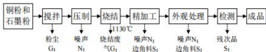
图 2-19 粉末冶金制造工艺流程及产污环节图
