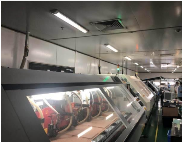
钻孔机自带的含尘废气收集装置
