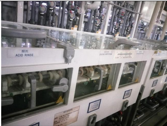
第二种生产线（水平）密闭槽
