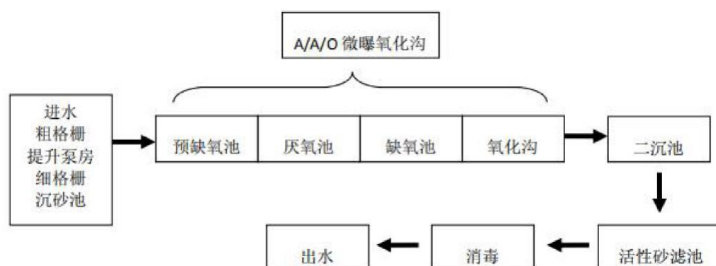
图5 开平市新美污水处理厂处理工艺流程图
