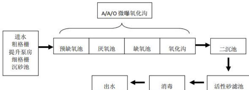
图 4-1 新美污水处理厂水处理工艺流程图
