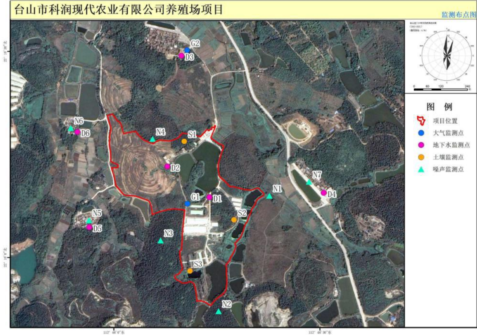
图 4.3-2 大气、地下水、土壤、噪声监测布点图
