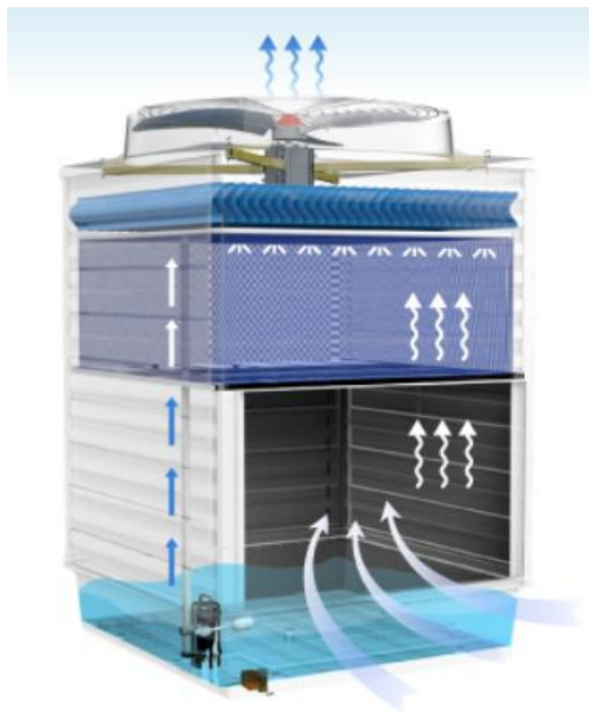
图 7.1-1 育肥舍一体化除臭系统
