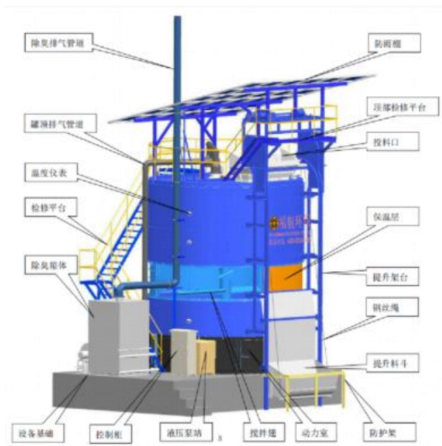
图 3.3-4 发酵罐设备结构图
