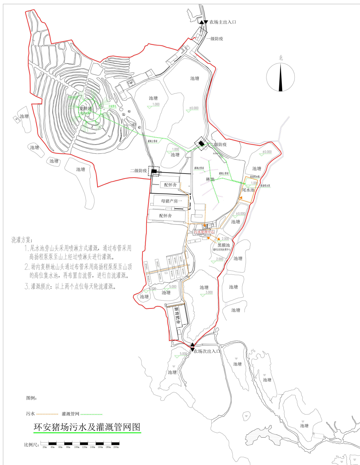
图 2.2-1b 现有项目污水管网及灌溉图
