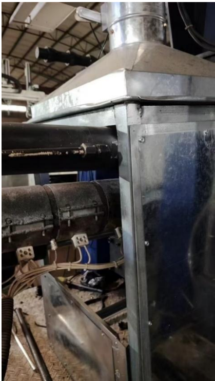
图 3. 集气罩示意图
