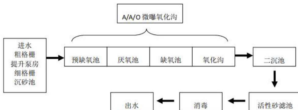
图 4-1 新美污水处理厂水处理工艺流程图
