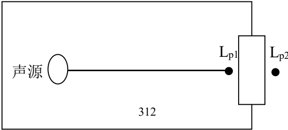
图 7.3-1 室内声源等效为室外声源图
