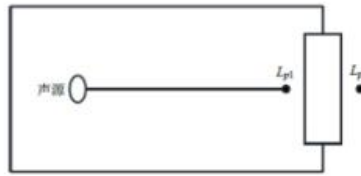
图4-2 室内声源等效为室外声源图例
